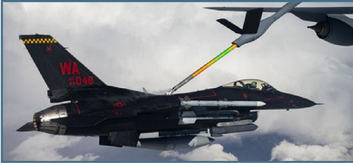
Betankung F-16 durch Stratotanker, Quelle: US Air Force
